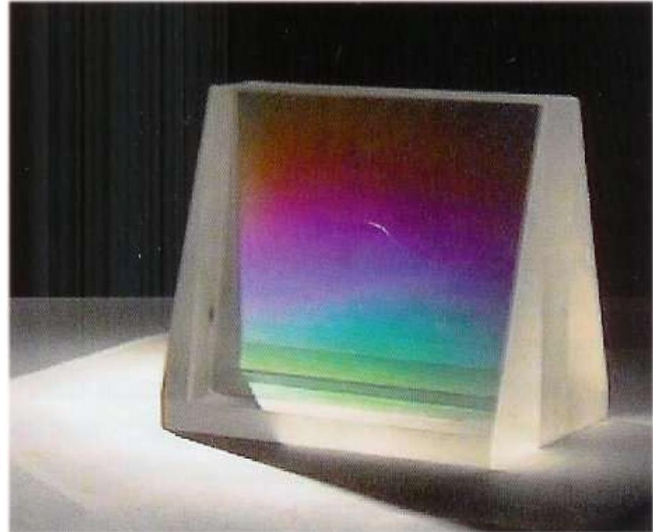
Na prática, funciona quase como um **grisma**, entre dois prismas. Assim, garante uma transmissão linear. O tipo de refração conseguida pela rede é como a de Bragg (mais típica de espectrometria em raios X – Secção 5.5.4A), em oposição à “normal” devida a sulcos num material.
