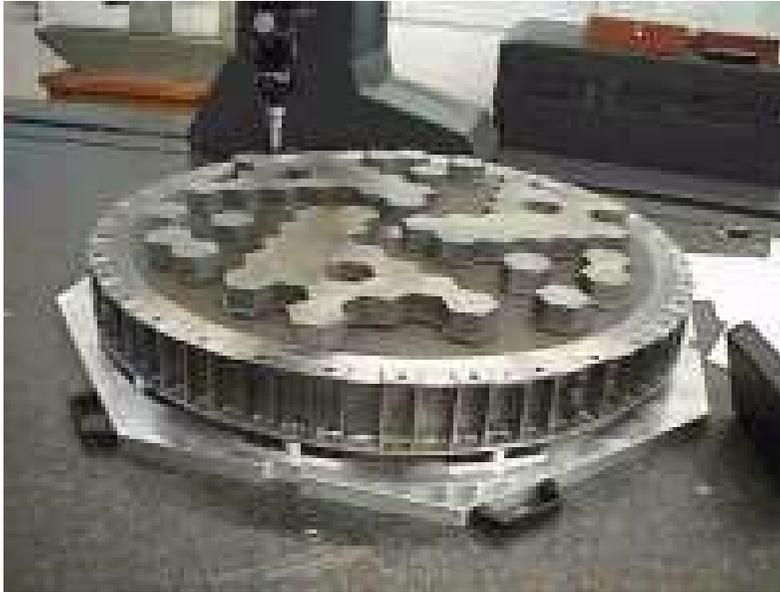
*A máscara na entrada do telescópio é composta de tungsténio (3cm de espessura) em 127 segmentos hexagonais, 63 opacos e 64 transparentes.*
