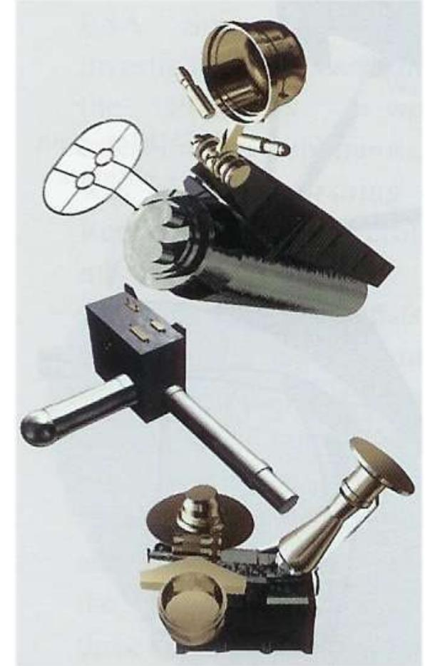
*Os três sensores do ROSINA. De cima para baixo, o RTOF, o COPS (câmara de equilíbrio à esquerda; sensor de pressão à direita) e o DFMS.*
