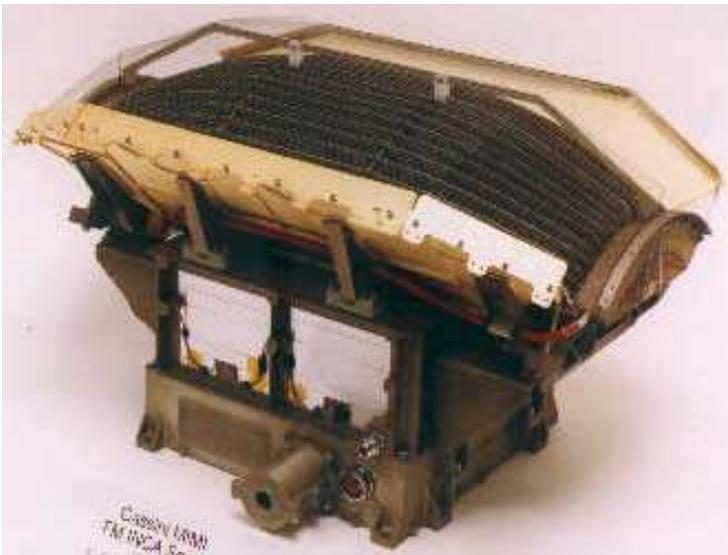
O **INCA** (Ion and Neutral Camera) também está no MIMI na Cassini. Consegue medir a direcção, energia e massa de ENAs o que permite determinar a distribuição global de iões na gama 7 keV – 8 MeV por nucleão, separando-os por espécie de energia e massa.
