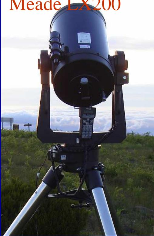
Uma das formas de montar altazimutalmente um telescópio é utilizando um *garfo* que segura o tubo em cada lado. É especialmente adequada para garantir um bom acesso à ocular em telescópios Cassegrain. Evita a necessidade de contrapesos.
