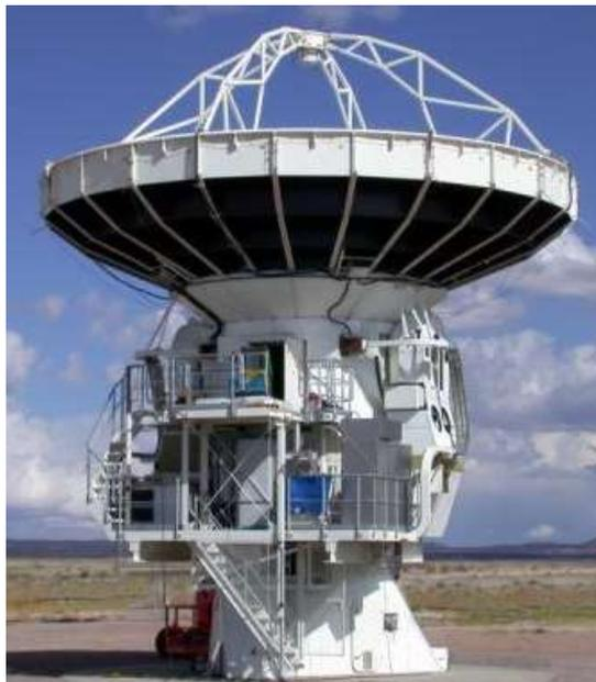
*Uma antena-protótipo do ALMA ( $D=12m$ ) em Socorro (Novo México).*
