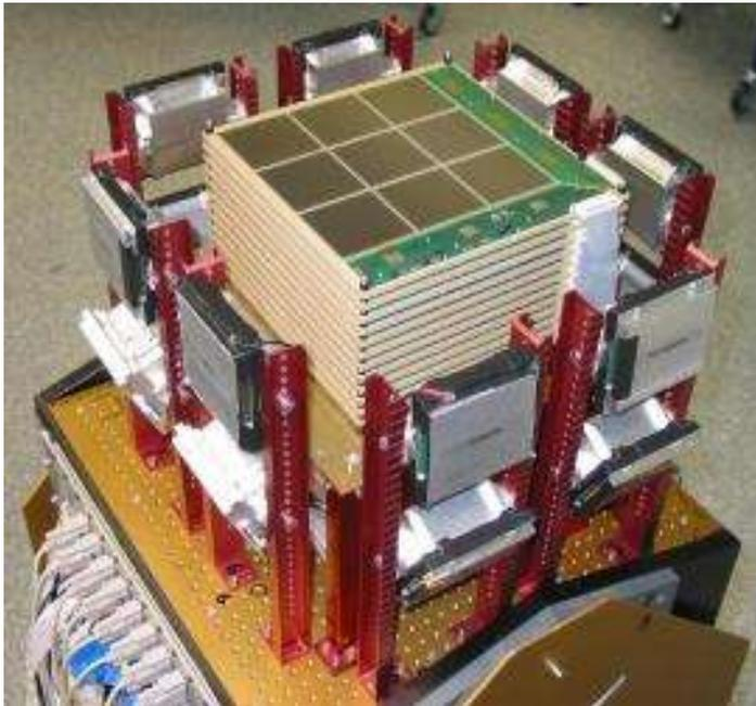
*O exemplo do detector (protótipo) do satélite MEGA (Medium Energy Gamma Ray Astronomy), para  $E < 50$  MeV. Este consiste na “câmara de recolha” (10 placas de silício de 0.5mm de espessura), que dá  $\sim 3^\circ$  de resolução, e nos “medidores” (24 calorímetros que a rodeiam).*
