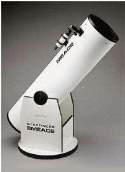
O Dobsoniano clássico. O **disco azimutal** permite rodar o telescópio em azimute enquanto o **eixo de altura** o permite fazer em elevação.
