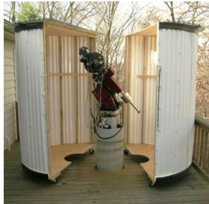
*Coluna de cimento com montagem equatorial Paramount em cima.*
