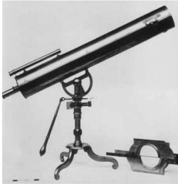
Figura 11 [18] - Telescópio reflector de foco gregoriano equipado com um micrómetro (na ocular).
