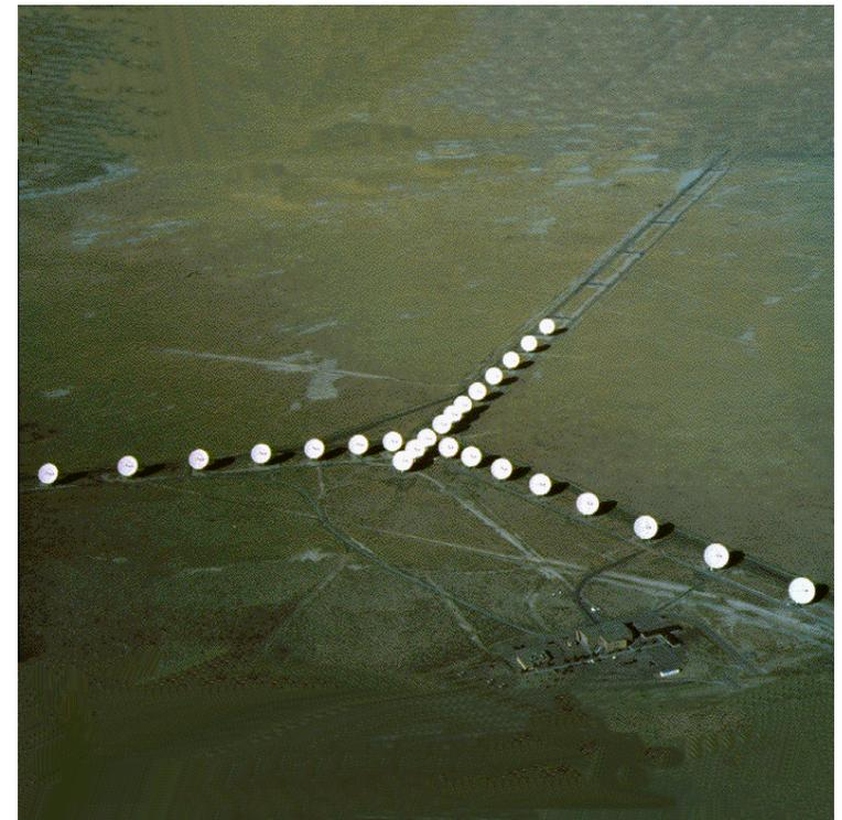
O VLA, o interferómetro mais sensível (e famoso) do mundo. Tem flexibilidade o suficiente para ter quatro comprimentos máximos: 1, 3.6, 10 e 36 km.
