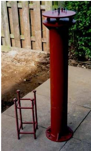
Um tipo de montagem altazimutal rígida é uma **coluna** (“pier”) de aço (ou cimento – ideal) em cima da qual se coloca o telescópio (e.g. o “garfo” da montagem altazimutal). A coluna prende-se a um chão de cimento, sendo o conjunto imune a vibrações (embora o aço seja propenso a estas, o cimento absorve-as).
