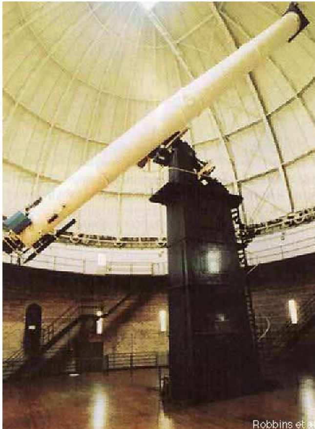
O telescópio de Yerkes, o maior refractor do mundo (1m de diâmetro).
