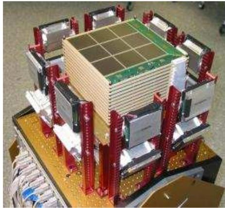
**Figura 1.33** – Um calorímetro deteta fotões incidentes devido a pequeníssimas diferenças de temperatura que são medidas. A direção de cada fotão é ajuizada devido a um conjunto de detetores auxiliares (em torno do calorímetro, que está no centro) e da própria construção do calorímetro em placas sobrepostas e em mosaico (no caso, de  $3 \times 3$ ).
